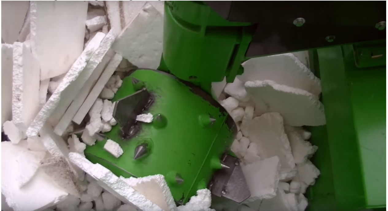
Sönderdelning och komprimering av frigolit:
